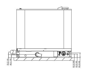
Mindestabstand bei Wandaufstellung (rechts) Minimum distance for wall installation (right) Distance minimale pour l'installation murale (droite)
